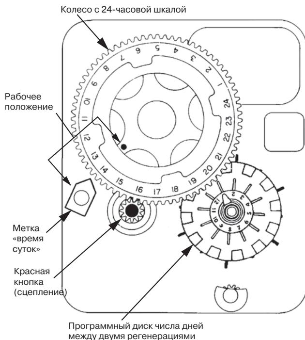
**Рис. 4. Таймер регенерации**
